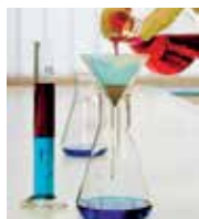
Séparateur de phase 1PS
