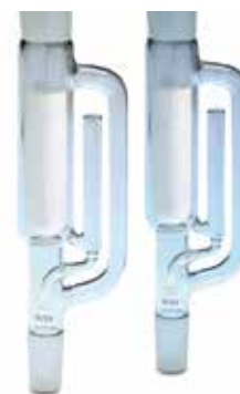
Fig 13. Cartouches d'extraction dans un appareil d'extraction de Soxhlet.
