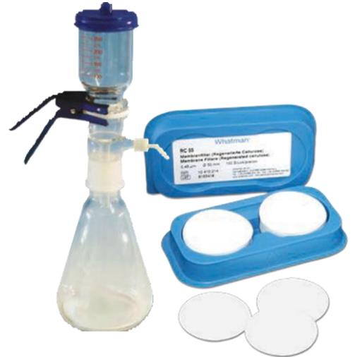
Vakuumfiltrationseinheit Whatman RC55 und GV 050/2 für Lösungsmittelfiltration
